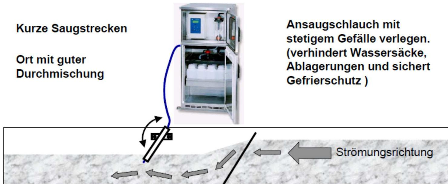
**Schräginbau des Entnahmestückes in Strömungsrichtung: störungsfreie Probenahme ohne Verstopfungen und Verzopfungen**
